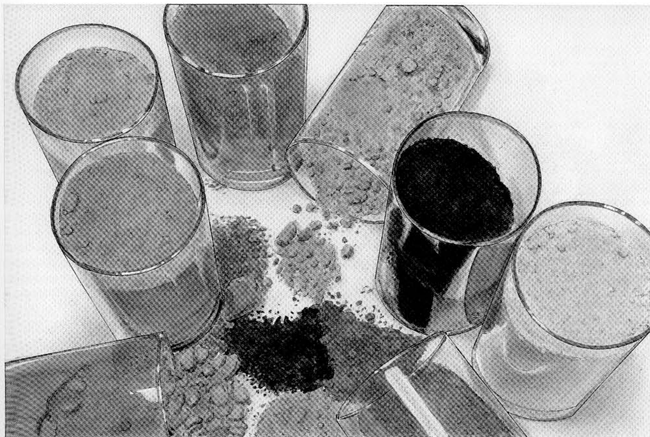
Divers types de pigments : bleu de cobalt, oxyde de chrome vert et oxydes de fer de différentes tonalités (rouge, jaune, brun, marron et noir).
