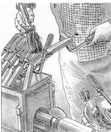
7. Nettoyage du fer au sortir du fourneau.
