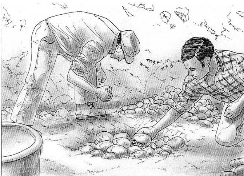
9. Défournage de la pierre calcinée.
