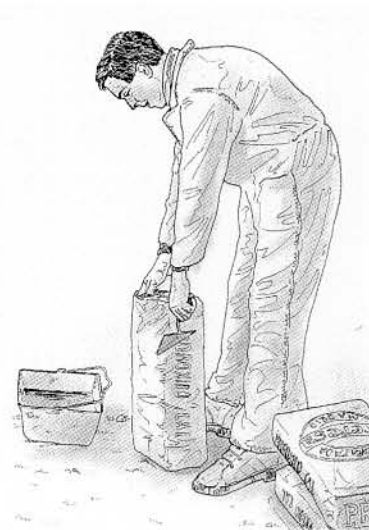
2. Ouverture des sacs d'hydrate de chaux.
