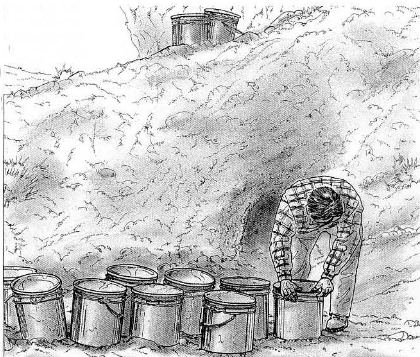
10. La chaux est stockée dans des bidons hermétiques.
