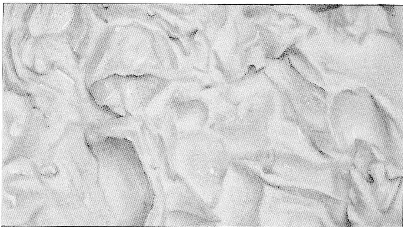
15. Texture et densité de la chaux obtenue au bout de 180 jours de repos.
