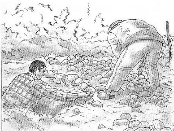
6. Chargement du four par l'extérieur avec des pierres calcaires.
