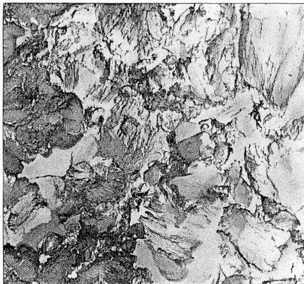
Vue microscopique d'une pâte de chaux récemment éteinte, aux cristaux trop grands et trop rapprochés. La plasticité de ce mortier sera donc faible.
