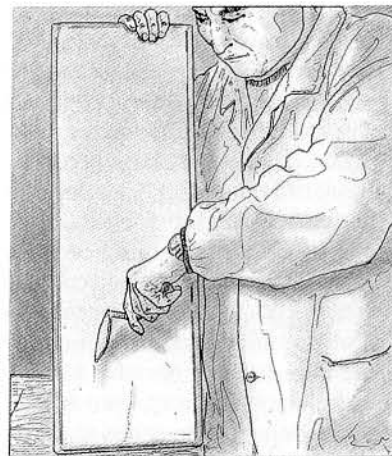
Mortier avec un dosage correct. La couche d'enduit ne se fendille pas et est suffisamment résistante. Au bout de 24 heures, la truelle ne peut absolument plus pénétrer dans le mortier.
