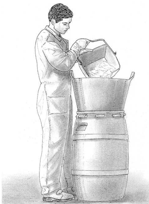
2. Tamisage de la chaux éteinte et froide.
