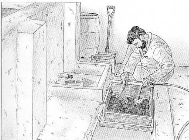
7. Nettoyage du tamis avec de l'eau potable.
