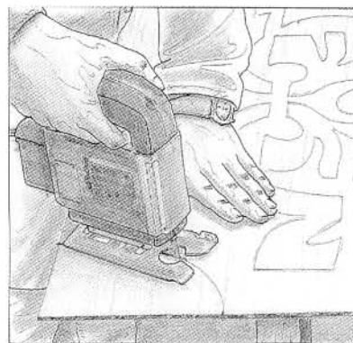
8. Découpe des contours du pochoir à la scie sauteuse.
