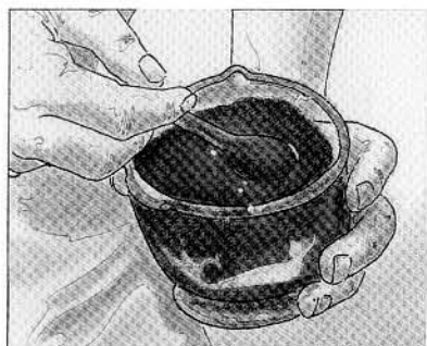
1 et 2. Dans des mortiers en verre, on mélange deux types de pigment avec de la chaux, à raison de 5 % de couleur.
